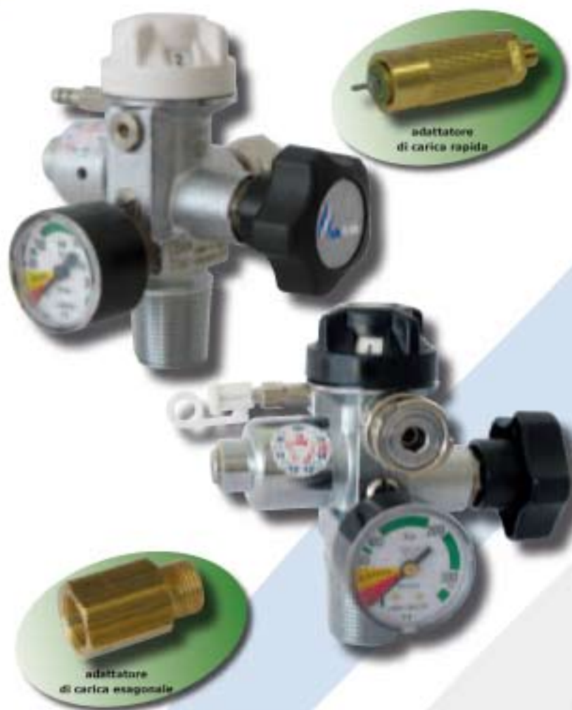
Valvola riduttrice con regolazione a scatto 0-15 lit. min. comprensivo di un riduttore a pistone bilanciato e sistema residuale. Per uso Ossigenoterapia
