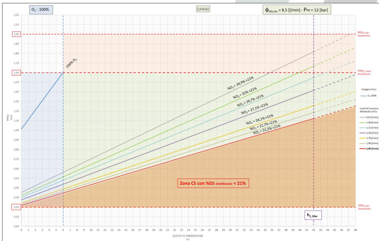
Livelli di PPO 2 funzione profondità e consumo O 2 - EAN 40% O 2 - Flusso 8,5 [l/min] - h max = 42 [m]
